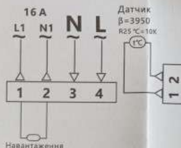
Схема підключення електричного опалення
